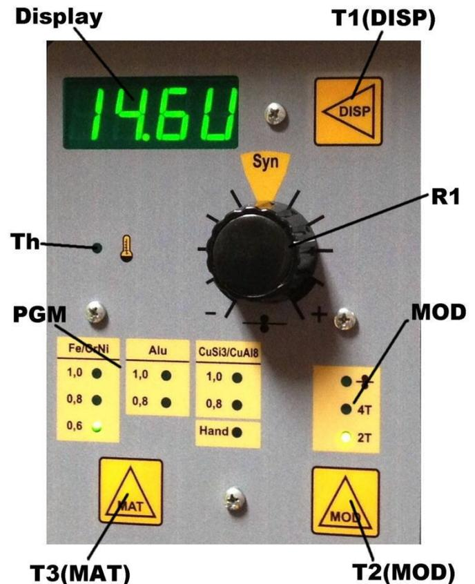
**Wichtig:** Mit **T3 (MAT)** wird das „synergische“ Materialprogramm auswählen, das zur momentan in der Maschine befindliche Drahtsorte passt. Das Programm muss nur beim Einlegen einer neuen Drahtsorte verändert werden.
