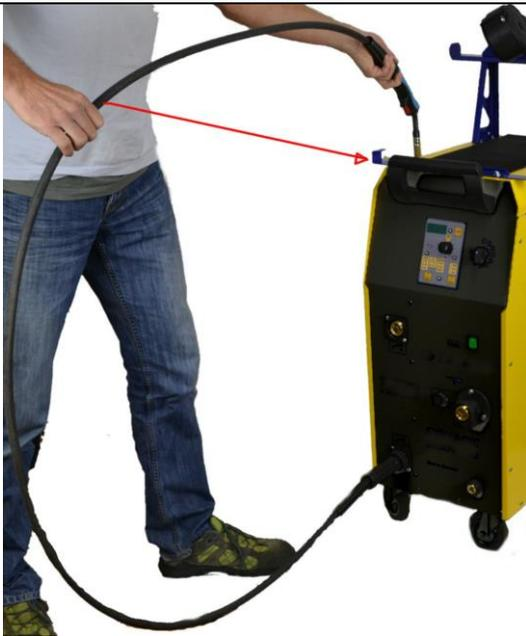
Das Schlauchpaket zunächst ausstrecken, dann den Brenner wie im Bild in Richtung des hinteren Brennerhalters zeigen lassen.
