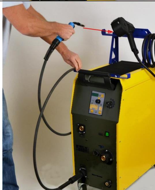
Schlauchpaket einmal um die vordere Halterung schlingen und Brenner in die Aufnahme im hinteren Teil des Halters stecken.
